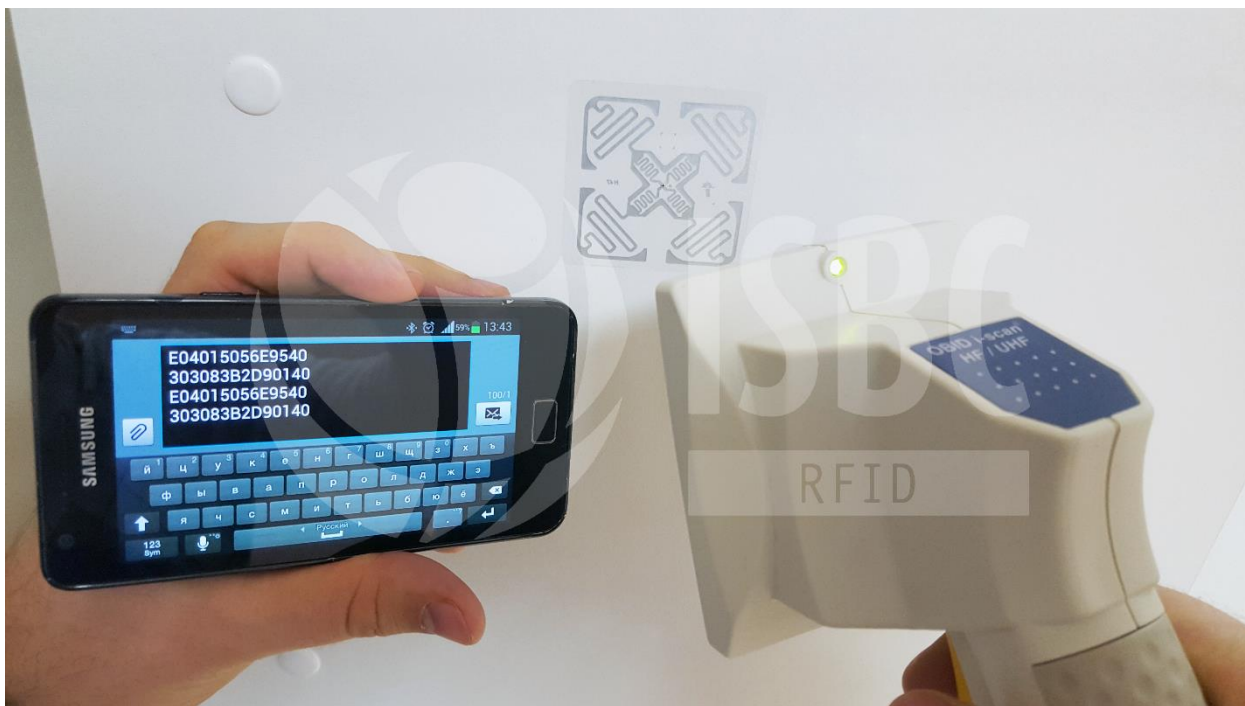
Рисунок 1. Пример решения задачи «Инвентаризация мебели», решенной с помощью ручного считывателя FEIG Electronic PRHD102-Bluetooth и коммуникатора на базе Android с последующей выгрузкой журнала обнаруженных RFID-меток в 1С
