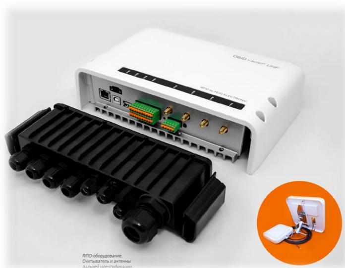
Считыватели FEIG ELECTRONIC работают с пассивными метками (транспондерами) стандарта EPC Class1 Gen2, ISO 18000-6. Данный тип меток не требует батареек или других элементов питания, следовательно, метки не требуют дополнительного технического обслуживания, срок их службы практически не ограничен. Метки могут быть выполнены в виде тонких наклеек на лобовое
